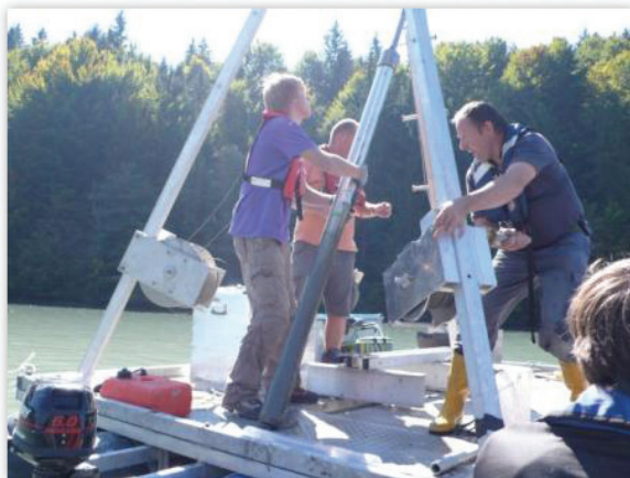
Odvzem vzorcev sedimentov za raziskavo podlage na zaježitvi Feistritz/Ludmannsdorf / Entnahme von Sedimentproben zur Untersuchung des Untergrunds im Stauraum Feistritz/Ludmannsdorf
